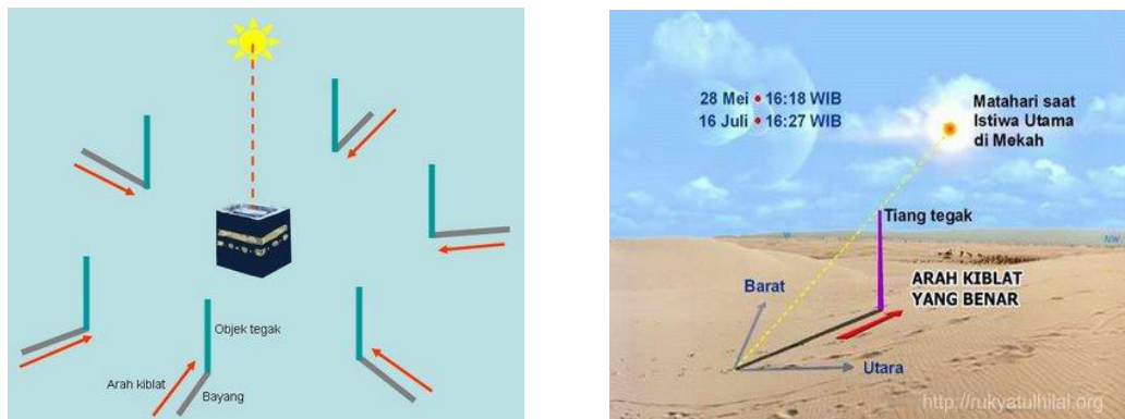
Gambar 1: ilustrasi matahari saat di atas ka'bah dan bayangan benda yang mengarah ke arah kiblat pada saat Raṣd al-Qiblat global.
