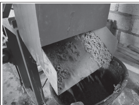
Gambar 2 Pencetakan bahan menjadi dengan mesing penggiling halus menjadi pelet
